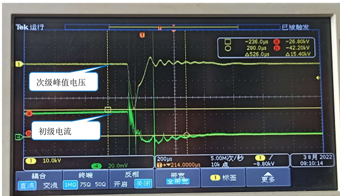
图 3 c) 次级峰值电压和初级电流
