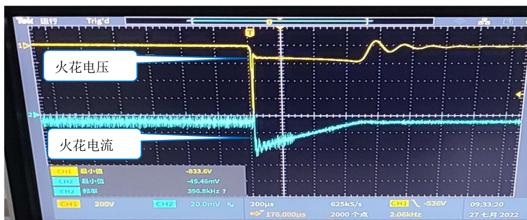
图 2 c) 火花电压和火花电流波形
