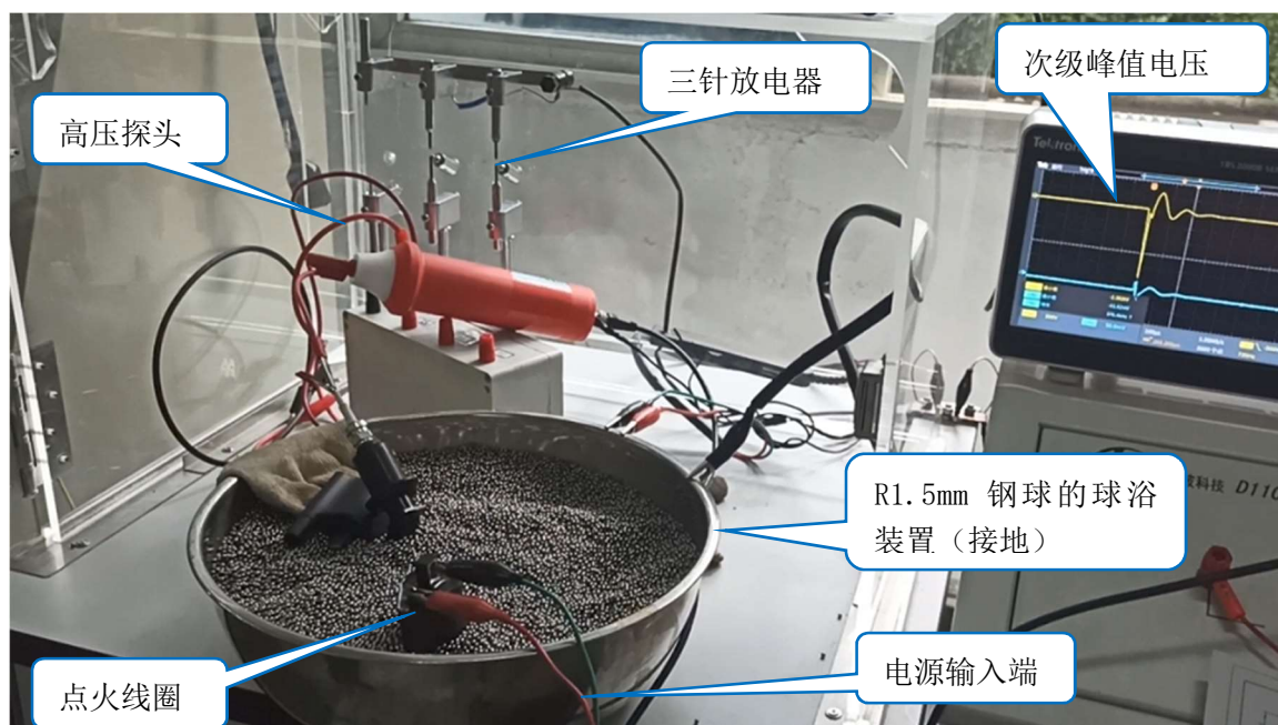
图4 绝缘性能试验装置
