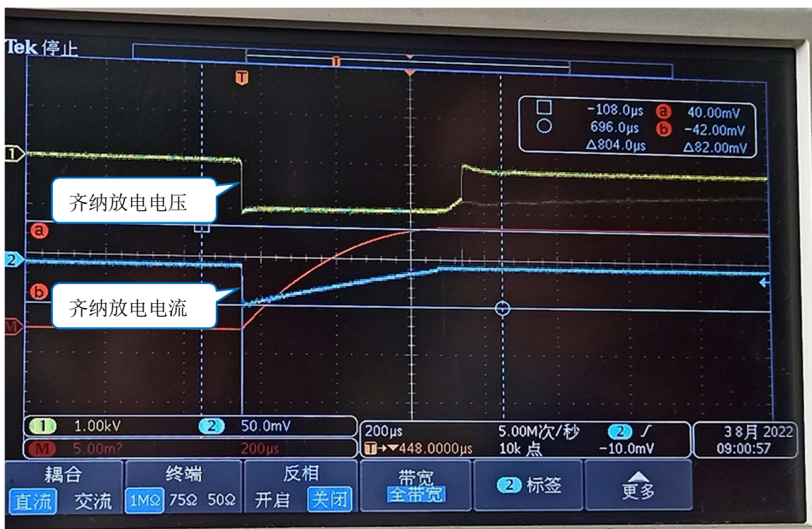
图 3 d) 齐纳放电电压和齐纳放电电流
