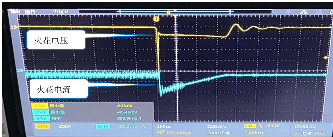
图 2 c) 火花电压和火花电流波形
