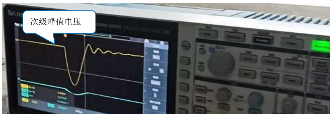
图 2 b) 次级峰值电压波形图
