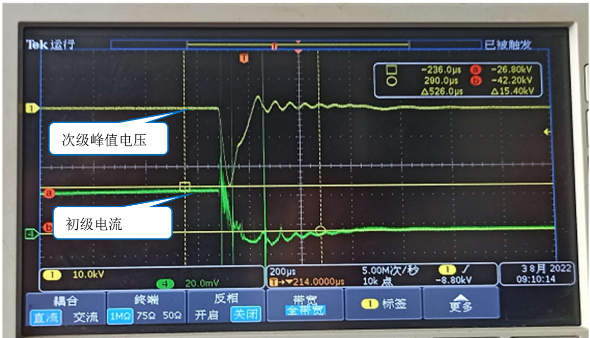
图 3 c) 次级峰值电压和初级电流
