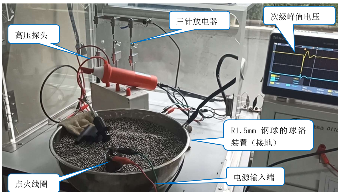
图 4 绝缘性能试验装置
